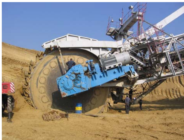
Слика 2. Зупчасти преносник радног точка роторног багера
